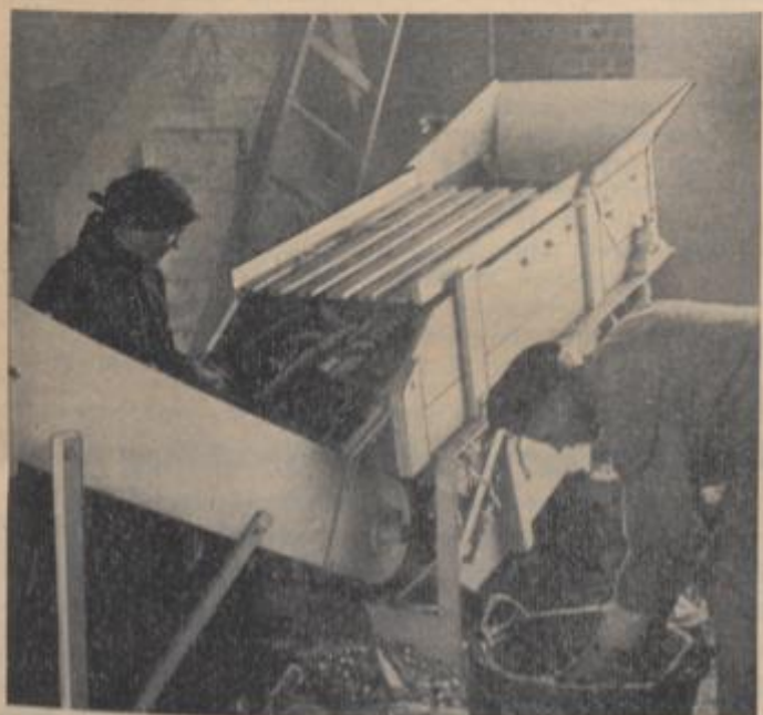
Für größere Betriebe lohnt sich die Anschaffung einer Maisentkörnungsmaschine. Mit ihrer Hilfe läßt sich gegenüber der Handarbeit eine 35prozentige Arbeitserparnis erzielen
