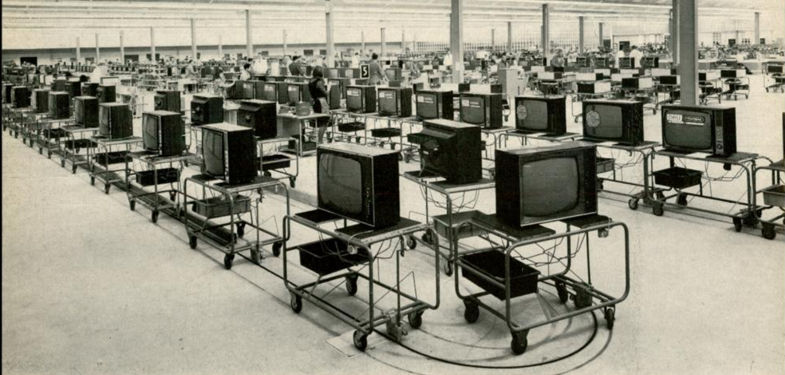
Blick in die große Montagehalle. Im Vordergrund ein Teil der Dauerprüfanlage mit Unterflurförderung
