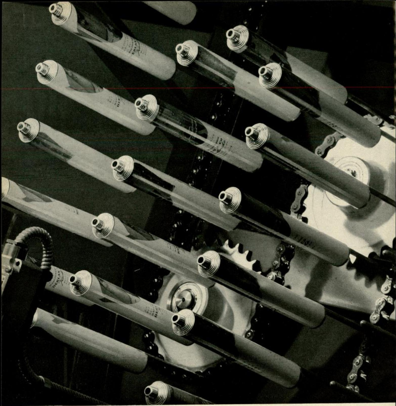
Bedruckte Tuben vor dem Einlauf in den Druckfarben-Trockenofen einer Tubenanlage HERLAN-TUBOMATIC
