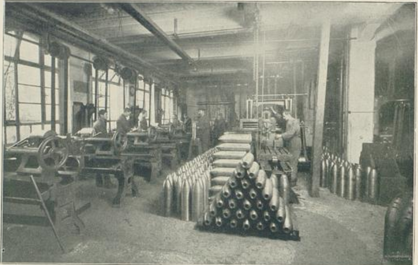
Granaten-Dreherei der Maschinenfabrik Herm. Haulsch.
