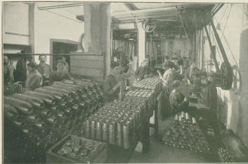
Granaten-Dreherei der Maschinenfabrik Herm. Haulick. Phot. Max Wiesener.
