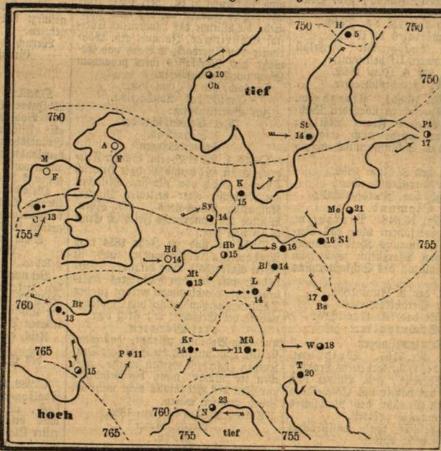
Erklärung. Die den Stationen beigefügten Zahlen geben die Temperaturgrade nach Celsius an; die den Kurven (Isobaren) beigefügten Zahlen bezeichnen den auf das Meer reduzierten Barometerstand in mm.
