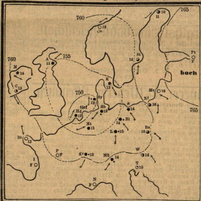
Erklärung. Die den Stationen beigefügten Zahlen geben die Temperaturgrade nach Celsius an; die den Kurven (Isobaren) beigefügten Zahlen bezeichnen den auf das Meer reduzirten Barometerstand in mm.
