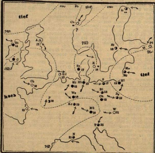
Erklärung. Die den Stationen beigefügten Zahlen geben die Temperaturgrade Celsius nach an; die den Kurven (Isobaren) beigefügten Zahlen bezeichnen den auf das Meer reduzierten Barometerstand in Millimeter.
