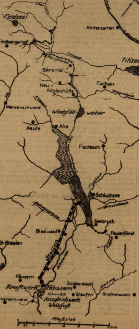
folgte durch die Wasser- und Straßenbauverwaltung in Karlsruhe. Das Schluchseewerk zerfällt hiernach in drei Stufen, die unabhängig voneinander je nach dem Kraftbedarf erstellt werden können, und nach Oberstufe, Mittelstufe und Unterstufe unterschieden sind.
