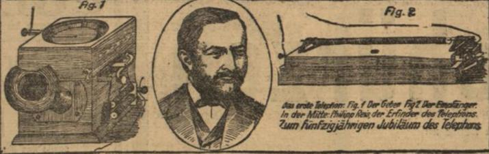
Das erste Telephon: Fig. 1 Der Geber Fig. 2 Der Empfänger. In der Mitte: Philipp Reis der Erfinder des Telephons. Zum fünfzigjährigen Jubiläum des Telephons.
