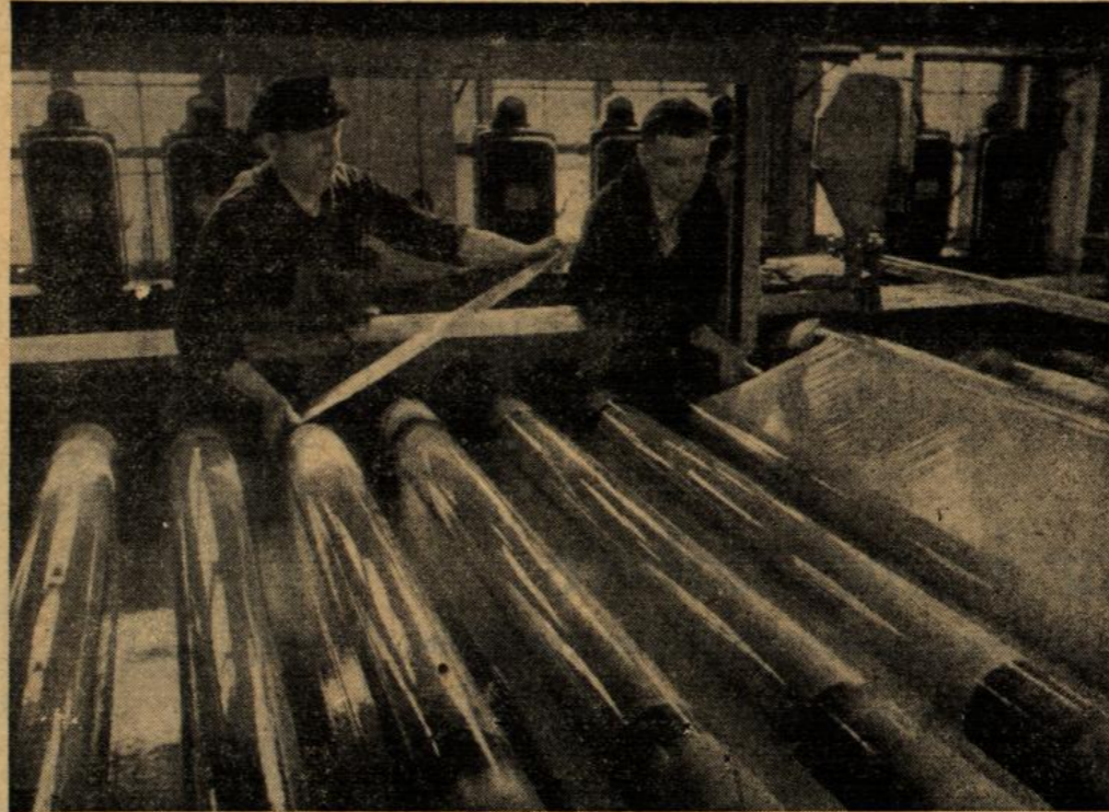
Ueber Hunderte von diesen Walzen wandert die Zellhaut, bis sie zum durchsichtigen Zellglas wird
