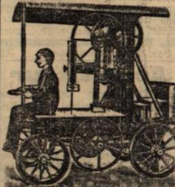
**Fahrbare Brennholz-Säge- und Spaltmaschinen,**
