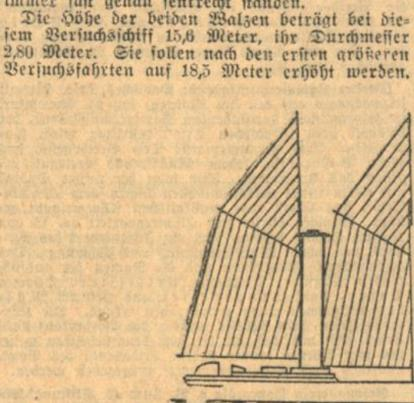
Vergleich der Angriffsflächen des Windes beim Segelschiff „Budau“ und beim Windkraftschiff.
