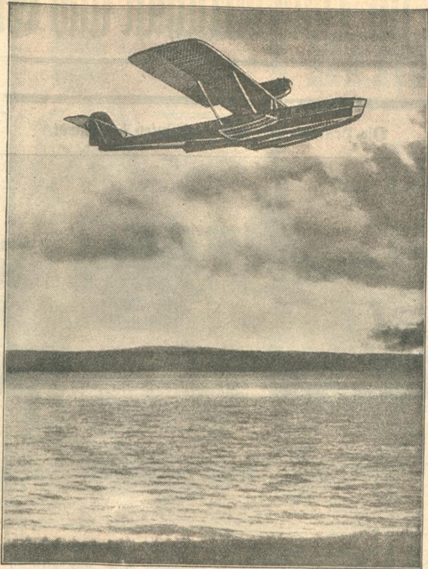
Die Dornierwerke in Friedrichshafen haben den Dornier „Superwal“, das größte Wasserflugzeug der Welt, vollendet. Das Flugzeug kann 25 Personen befördern. Länge 23,5 Meter, Breite 28 Meter, Schwimmflößenbreite 7,5 Meter.
