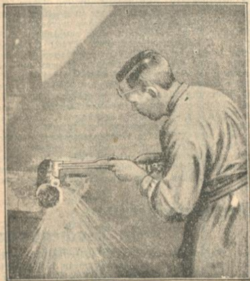
Der Kombinationsbrenner beim Schweißen.
