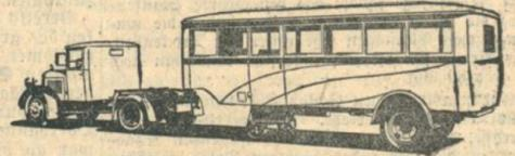
Mercedes-Benz Diesel-Sattelzugmaschine mit Omnibus-Anhänger (abgeparkt)
