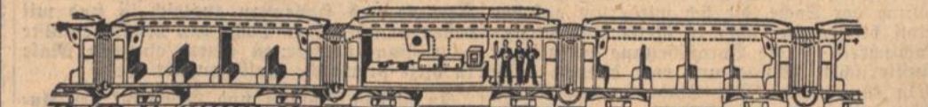
Die Telefunken-Lautsprecheranlage im Eisenbahnzug. In der Mitte der Verstärkerwagen mit Plattenspielern, zwei B-Verstärkern, Rundfunk-Empfänger und Mikrophon. In jedem Wagen 2 Lautsprecher.
