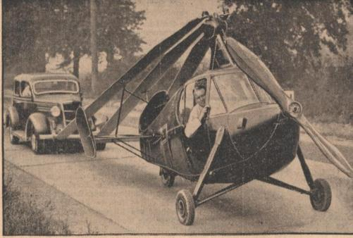
(Breffephoto, M.) Durch die Luft und über Stragen Das amerifanische Bitcairn-Autogiro, das über Strafen fabren und durch die Lufte fliegen tonn, Die Alugel tonnen mit wenigen Sandariffen gufammengeflappt werden
