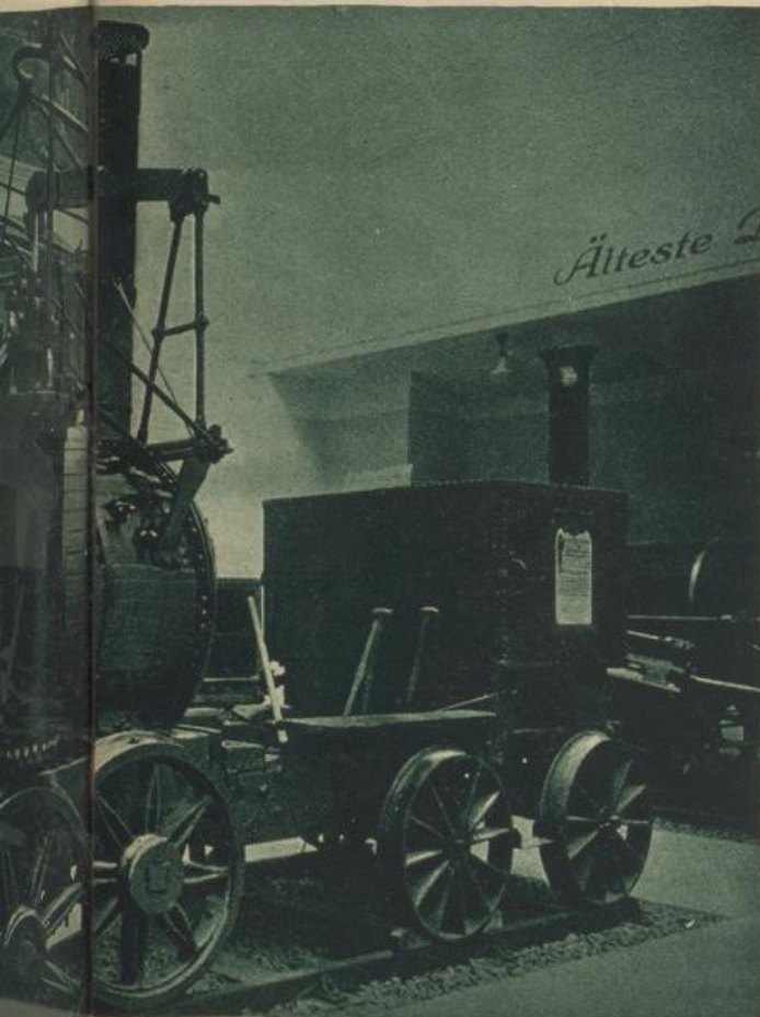
älteste Lokomotive, die 1825 in England gebaut wurde. Diente zur Beförderung von 10 beladenen Kohlenwagen 8-10 km
