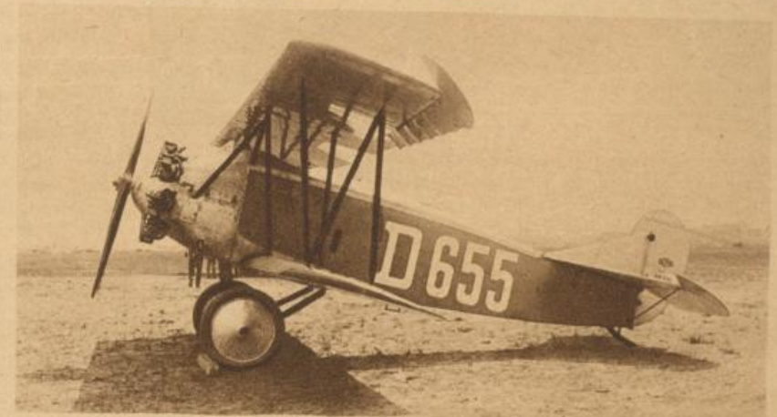
Der Dietrich-Doppelbedeker mit Siemens 27 PS-Motor
