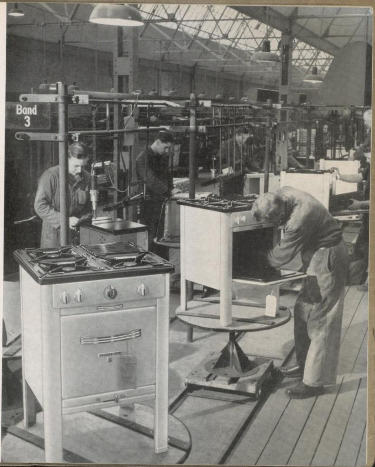
Bandauslauf im Herdbau
