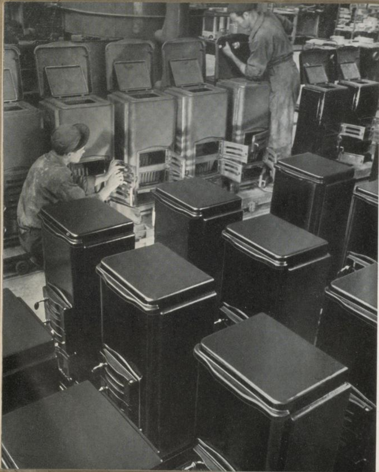
Ofenmontage am Fließband
