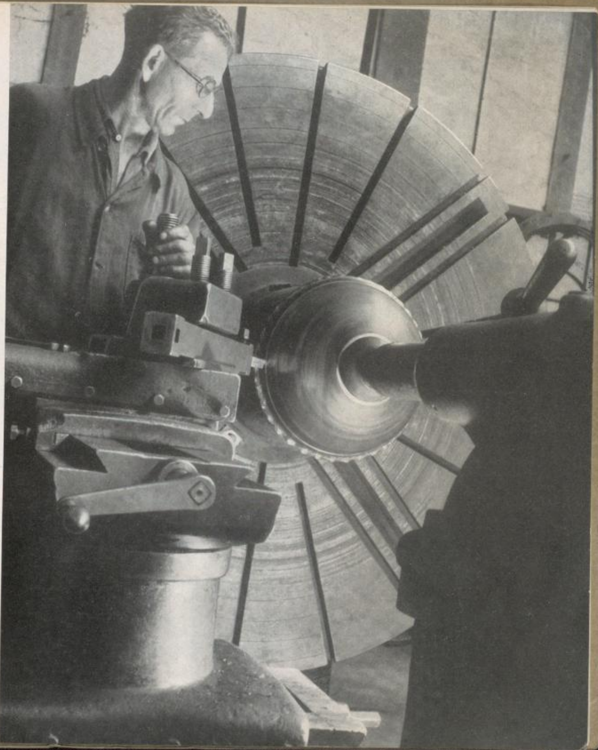
Kopfdrehbank im Kesselbau
