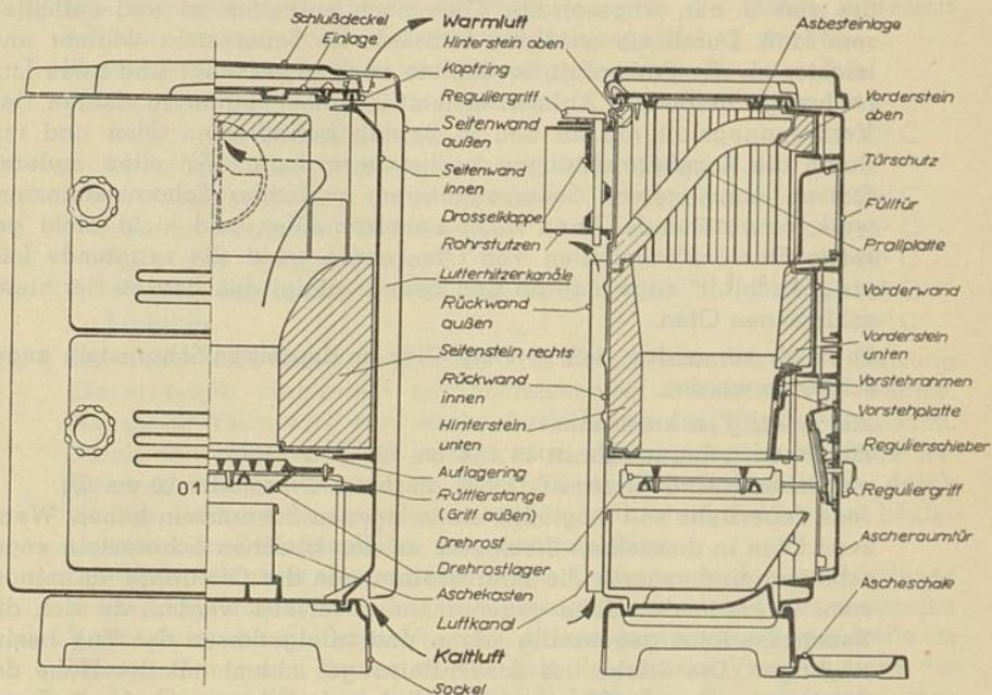
Ein mit Schamottesteinen ausgemauert Füllschacht wird am unteren Ende durch die Rüttelrosteinrichtung abgeschlossen, welche bequem durch die Aschetür ausgewechselt werden kann.
