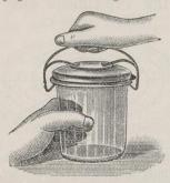
Mit der einen Hand wird das Glas, welches in gleicher Weise wie zur Aufnahme in den Apparat vorbereitet ist, festgehalten und mit der andern Hand wird der Bügel auf der Mitte aufgesetzt, dann nach unten gedrückt, bis die Klammern unter den Kand des Glases eingreisen.
