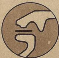
Auch hier haben Glas und Deckel **geschliffene** Auflageränder. Die nebenstehende Zeichnung zeigt, wie der geschliffene Deckelrand auf dem breiten plangeschliffenen Flachrand des Unterteils aufliegt. Der durch einen schwarzen Strich dargestellte Gummiring liegt auf dem breiten Flachrand **glatt auf**. (Siehe auch Seite 8.)
