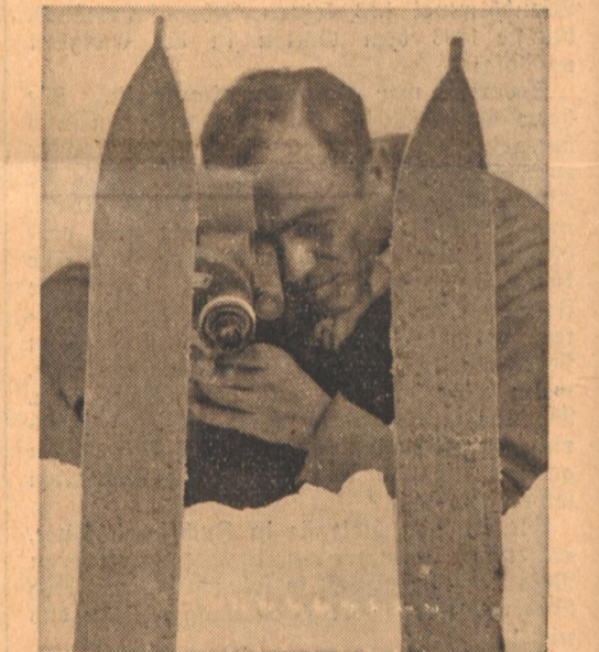
Die mit Federwerk arbeitende automatische Handkamera wird knapp vor der Bindung des Skis befestigt. Die Auslösung erfolgt durch Zug an einer Strippe.
