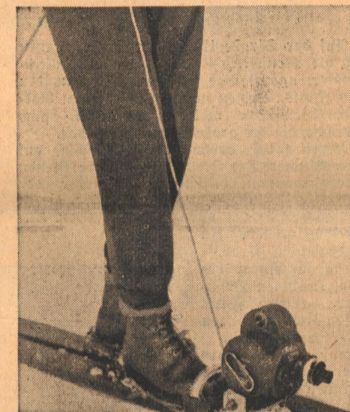
Die mit Federwerk arbeitende automatische Handkamera wird knapp vor der Bindung des Skis befestigt. Die Auslösung erfolgt durch Zug an einer Strippe.
