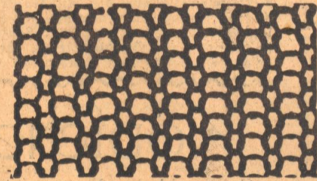
Maschengewebe eines Strümpfes in der üblichen Webart.
