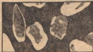
Grobes Scheuermittel feucht, 40 mal vergrößert. Die spitzen und groben Mineralsplitter verursachen Kratzer
