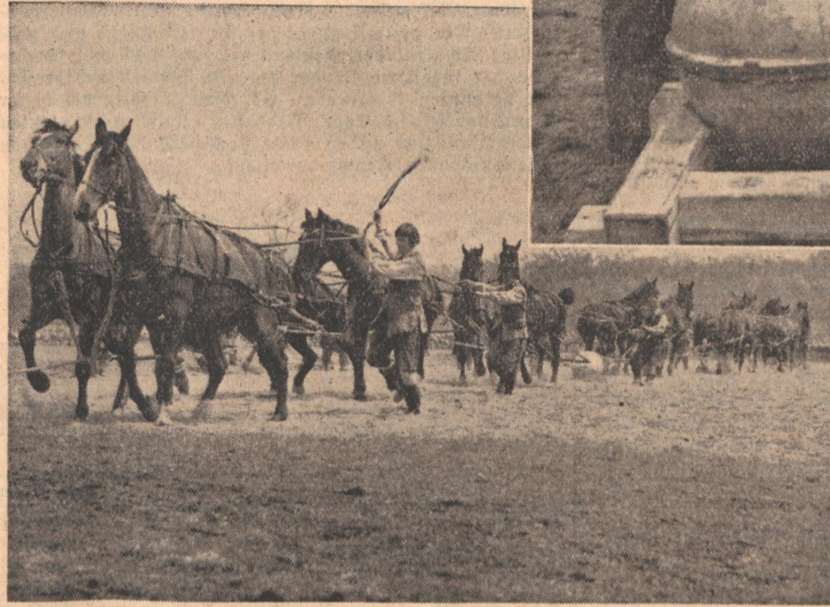
Oben: Die Halbkugeln werden luftleer gemacht. Unten: 16 Pferde bemühen sich, die Kugeln auseinanderzutreiben.
