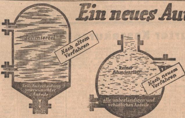
Rohoel enthält von Natur aus neben erstklassigen Schmierstoffen unerwünschte und schädliche Kohlenwasserstoff-Gruppen, wie Teere und Harze, die Rückstände an Kolben, Ventilen und Ablagerungen im Kurbelgehäuse bilden.
