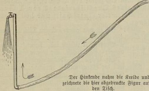
in die geschlossenen Röhren gepreßt und sucht einen Ausweg. Es hat Druck oder Spannung. Dieser Druck treibt es im Hause aufwärts, und wenn der Hahn geöffnet wird, so strömt es mit Gewalt aus.
