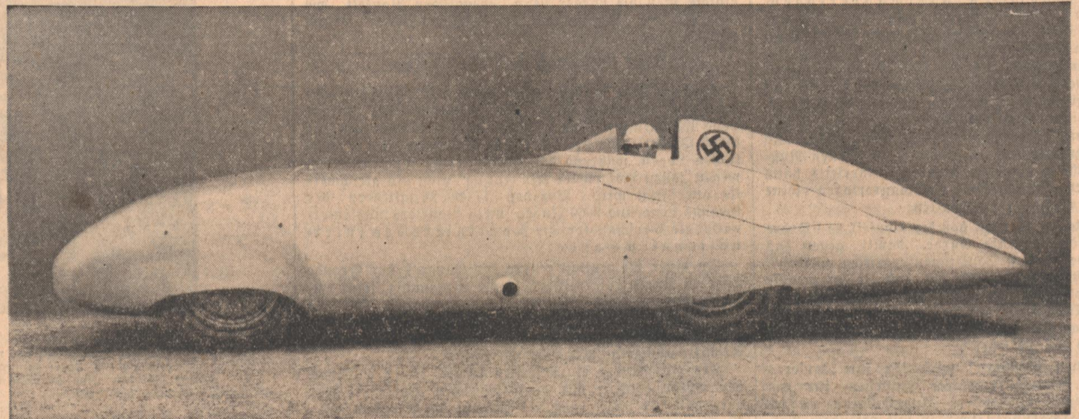
Das ist der neue Mercedes-Benz-Rennwagen mit 5,6 Liter, N-Form-Motor und der Stromlinienförmigen Leichtmetall-Karosserie, die einem Segment einer Flugzeugtragfläche ähnelt. Am Steuer Rudolf Caracciola.
