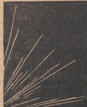
Sichtbarmachung des Weges von alpha-Strahlen in Luft nach C. T. Wilson.
