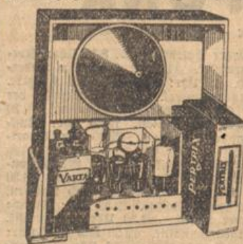
Abb. 1. Der Schnitt durch einen neuen Batterieempfänger zeigt den einfachen und klaren Aufbau der Geräte und den Einbau der Batterien (Roland-Brandt).
