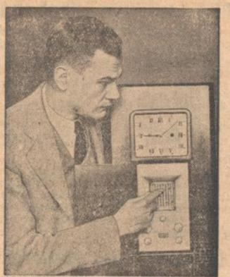
Das Neueste auf dem Gebiete der Rundfunktechnik stellt ein automatischer Radio-Einsteller dar, der von dem Ingenieur Stawinski in Neusorf erfunden wurde. Der Apparat schaltet selbsttätig zur gewohnten Zeit bis zu 6 verschiedenen Radiostationen nacheinander ein, so daß man sich jetzt mit keiner Hilfe aufwecken lassen kann.
