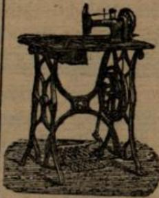
mit neuer, patentirter Schwungrad-Auslösung, welche das Fadenspulen sehr erleichtert, indem das Werk außer Thätigkeit gebracht wird.
