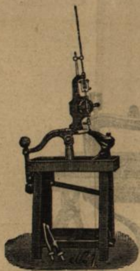
Nr. 1 Patent-Maschine zum Verschrauben von Schuhwaaren, Lederwerk, Treibriemen etc. etc. auf Holzgestell.
