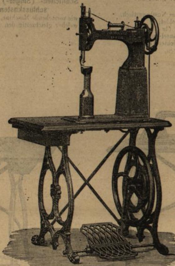
Nr. 2 Patent-Maschine zum Verschrauben von Schuhwaaren, Lederwerk, Treibriemen etc. auf Säulen- gestell.
