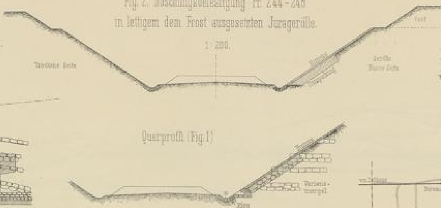
Fig. 1. Böschungsbefestigung bei Wasserzutritt aus den Variansmergelschichten.
