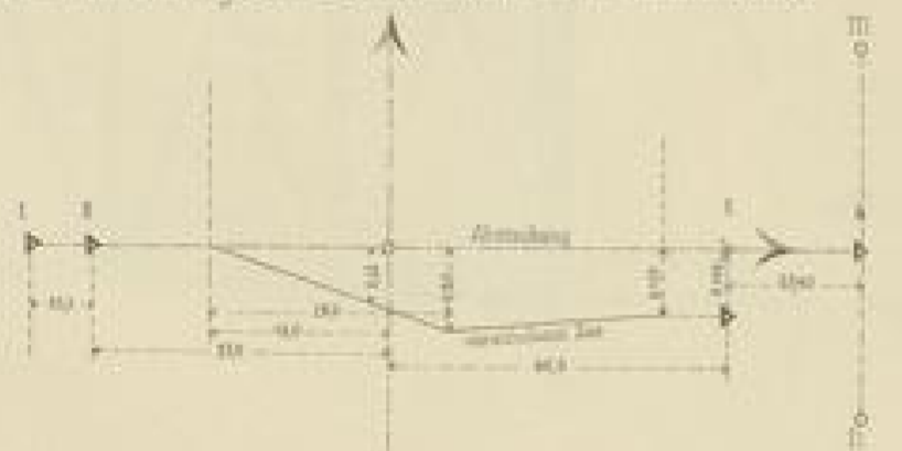
Fig. 4 Verschiebung der Bauaxe während d. Rutschs
