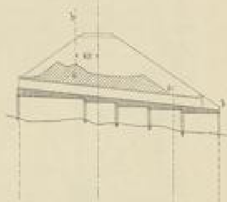
Fig. 3 Profil in der Axe des Durchlasses Stand vom 7. Januar 1889 1:1000
