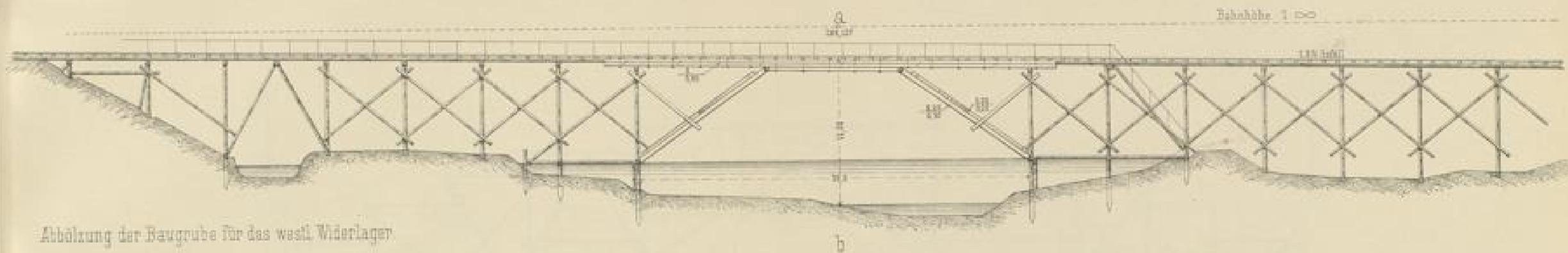
Abbildung der Baugrube für das westl. Widerlager
