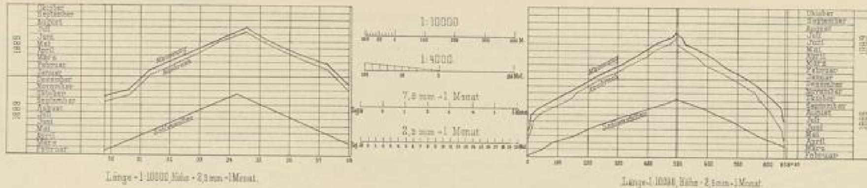
Fortgang des Ausbruches u. der Mauerung der einzelnen Gewölbringe.
