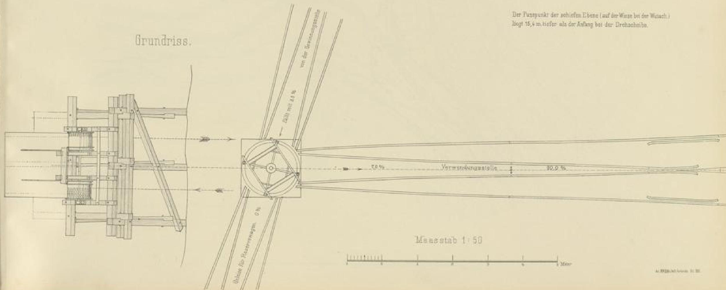
Der Fixpunkt der schiefen Ebene (auf der Wiese bei der Wutach) liegt 15,4 m tiefer als der Anfang bei der Drehachse.
