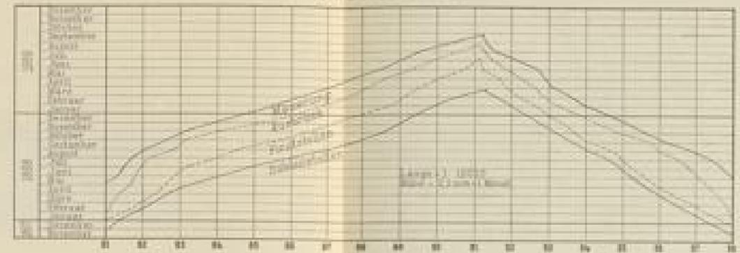
Fortgang des Ausbruches u. der Mauerung der einzelnen Gewölbränge.
