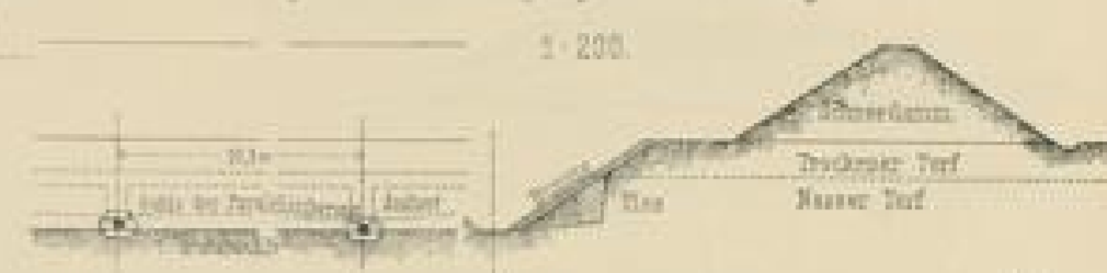
Fig. 3. Trockenlegung der Böschung Pt. 259.
