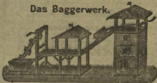
Ein neues Betriebsmodell für die Dampfmaschine! Ganz leichte Bauart. Das Baggerwerk kann entweder mit der Hand oder mit einer kleinen Dampfmaschine in Bewegung gebracht werden. Die Eimer baggern aus dem Behälter den Sand aus und bringen denselben nach den obenstehenden Wagen.
