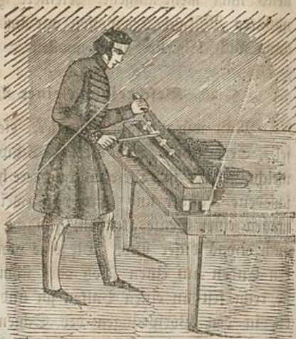
Würgen der Schwärmerhülsen mit der Würgscheere.
