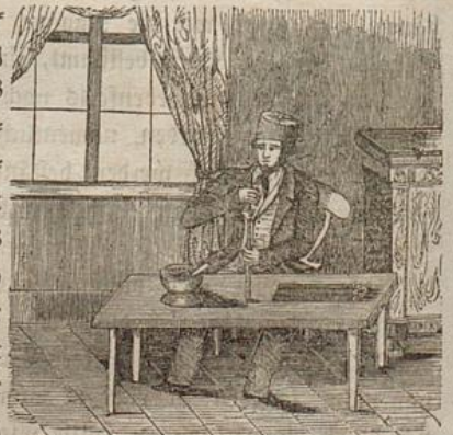
Das Füllen der Tuben zu Pastillen mittelst eines kleinen Trichters.
