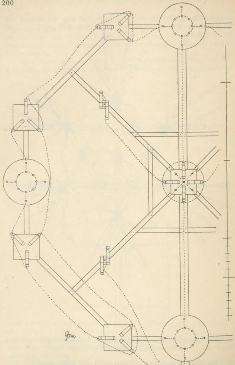
Fig. 103. Rosettenfeuer aus 28 Brandern, 4 zweihülsigen Umläufem und 53 Lichtern.
