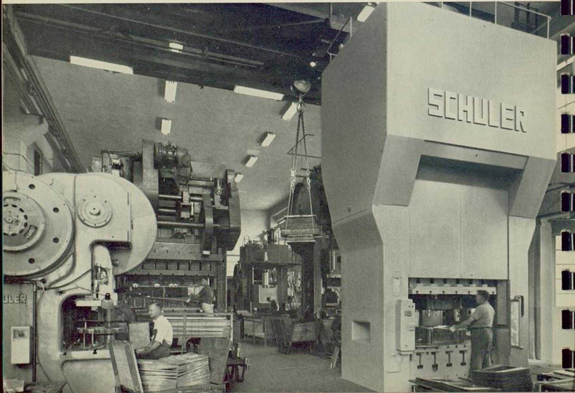
Herde bestehen zum überwiegenden Teil aus Blech – aus Qualitätsfeinblechen. Diese Bleche (meist 2×1 m groß und 0,63–2 mm stark) werden zugeschnitten und in Pressen «verformt», wie der Fachmann sagt, das heißt gestanzt, gebogen, gezogen. Die großen Ziehpressen haben eine Druckleistung bis zu 750 000 kg.
