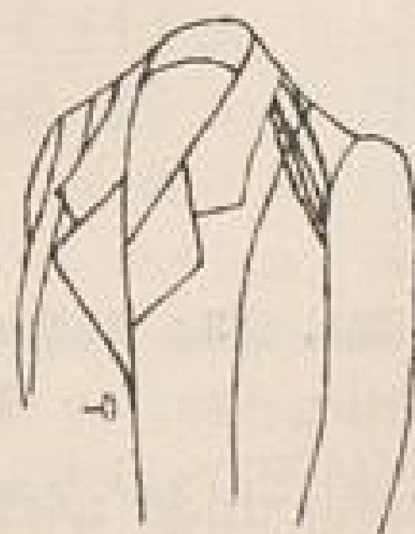
Abb. 151. Zu kurz aufgesetzter Kragen oder schlechte Lage des Halsloches.
