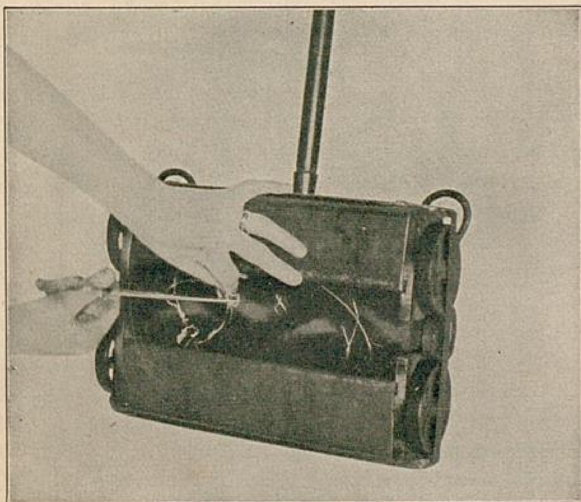
Ausschneiden der um die Rollen gewickelten Fäden an der Teppichkehrmaschine
