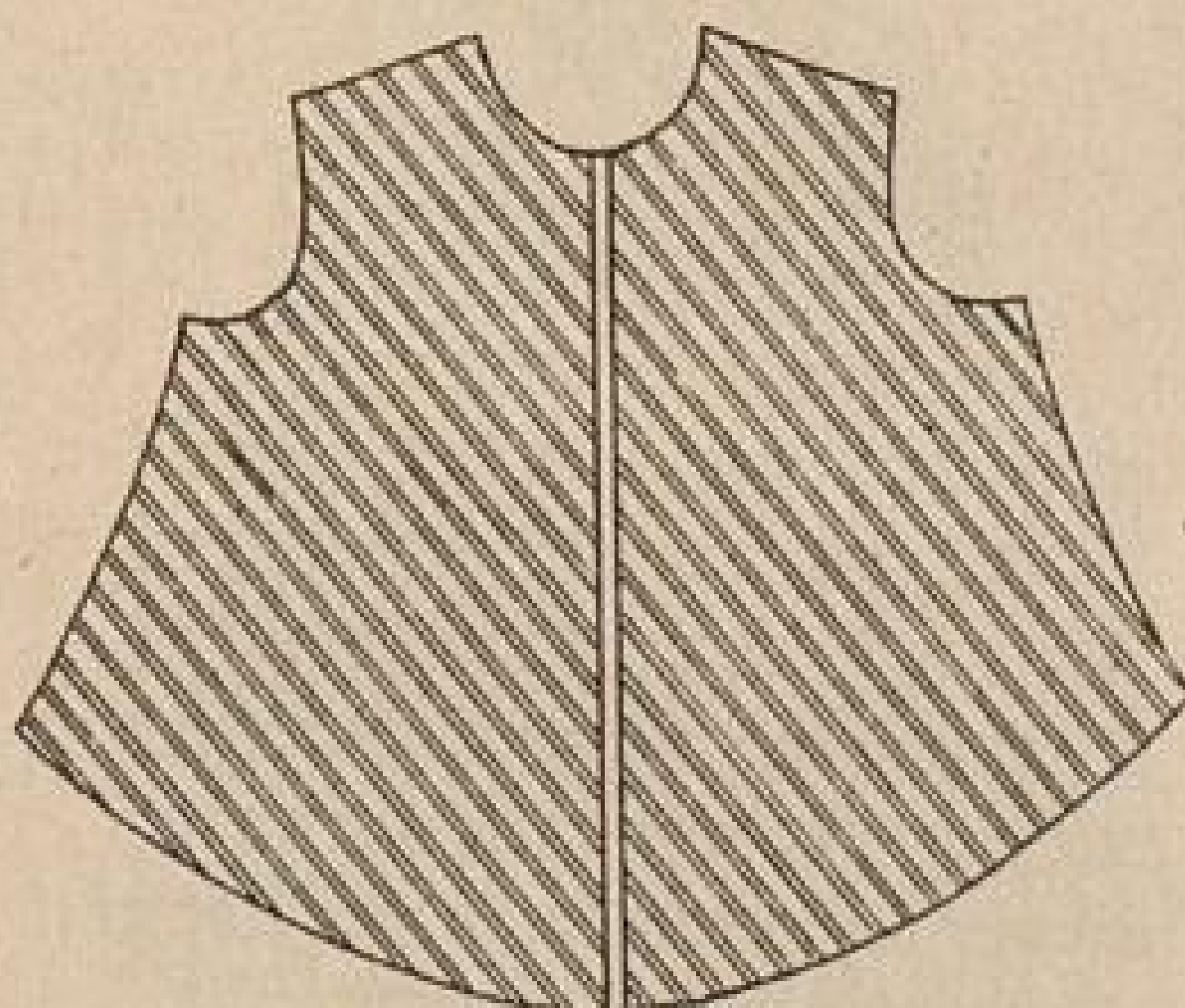
Abb. 7a. Falsch zugeschnittene Vorderteile aus gestreiftem Stoff.
